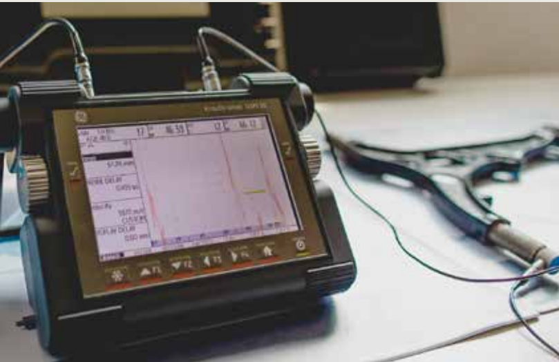
Ультразвуковой контроль образования трещин в литых деталях
