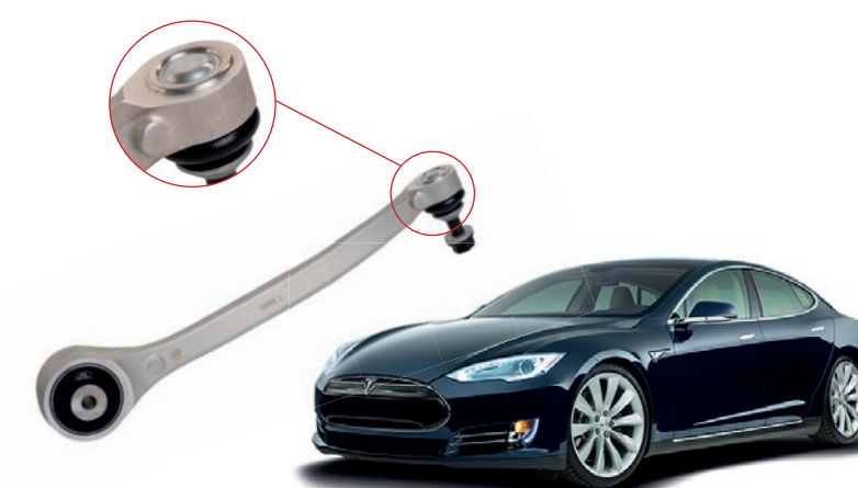
Giunto sferico incorporato nel braccio di controllo della carreggiata per Tesla.
