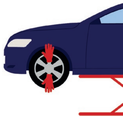
Controleren op speling op de wiellager
