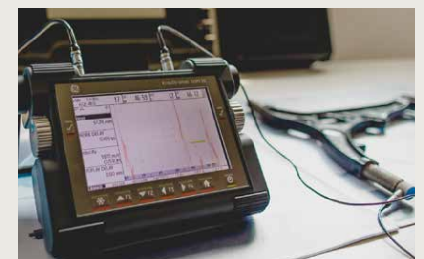
Control ultrasónico de grietas en piezas fundidas
