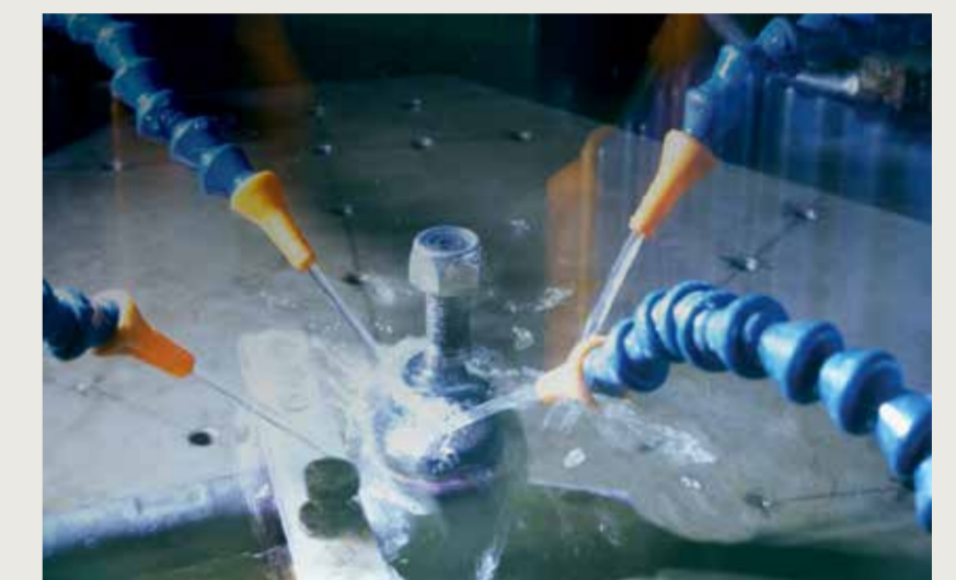
Tests op waterinfiltratie
