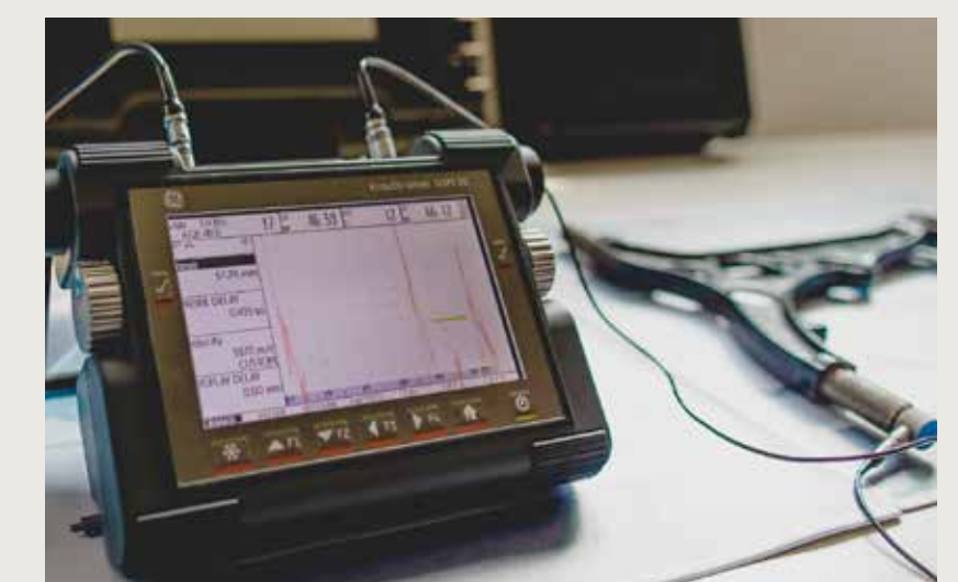
Ultradźwiękowa kontrola pod kątem pęknięć w częściach odlewanych
