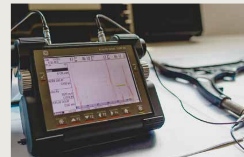
Controlul cu ultrasunete pentru detectarea fisurilor în cazul pieselor turnate
