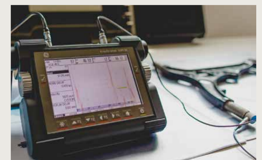
Ультразвуковий контроль утворення тріщин у литих деталях
