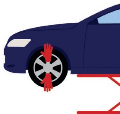
Controleren op speling op de wiellager
