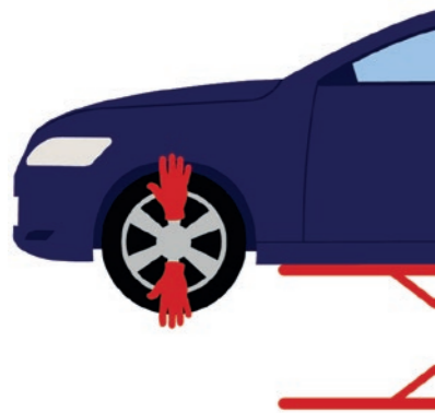
Перевірка підшипника колеса на люфт
